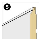
Panneaux isolants 40 mm acier et mousse polyuréthane
