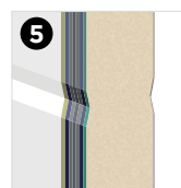
Remplissage panneaux acier et mousse isolante 40 mm
