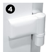
Paumelles réglables 3D (ouverture int. : blanches ; ouverture ext. : blanches si profils blancs et inox si profils de couleur)
