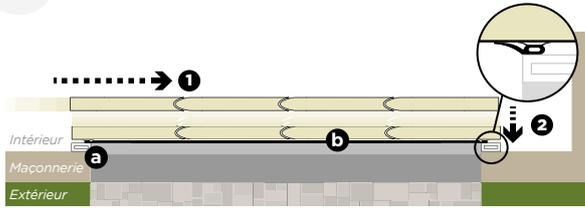
Système de fermeture à frappe par translation. Cadre et seuil équipés de joints périphériques en EPDM tubulaires à triple lèvres assurant l'étanchéité du garage lors de la compression de la porte.
